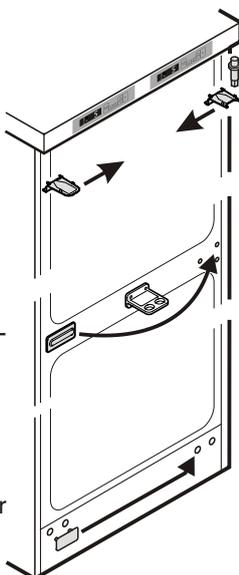
13. À l'aide de la clé plate fournie, tourner le système à ressort de la porte du réfrigérateur dans le sens inverse horaire, jusqu'à ce que la tête hexagonale s'enclenche dans la découpe du support intermédiaire.
