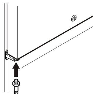
11. Ôter le système à ressort de la porte du réfrigérateur et le monter sur le côté opposé.
