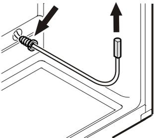
Introduire la sonde dans l'orifice et sécuriser le câble de la sonde au moyen de la décharge de traction.
