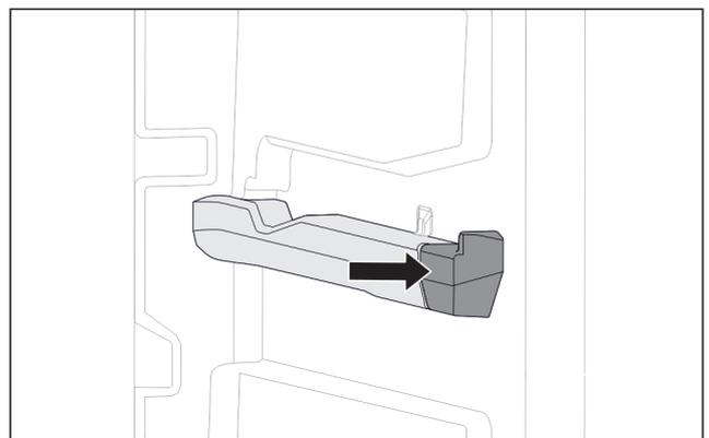
Fig. 71 Élément emboîtable sur la nervure de récipient droite
