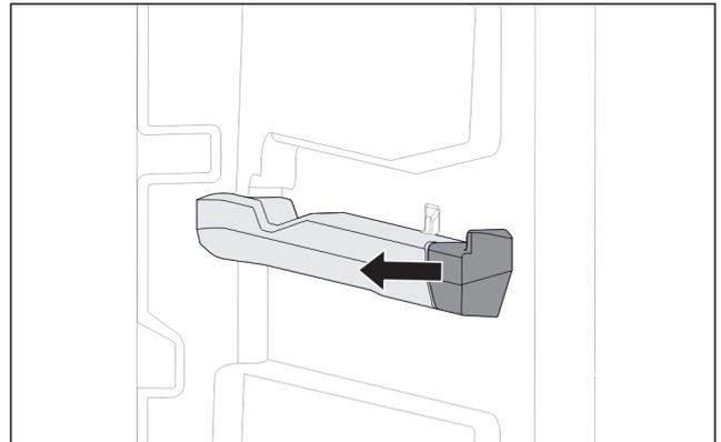
Fig. 69 Élément emboîtable sur la nervure de récipient droite
