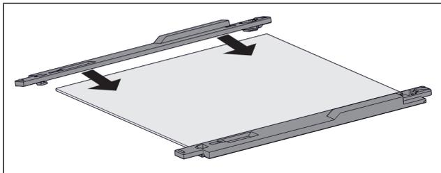
Fig. 80 Tablette en verre avec pièces de retenue
